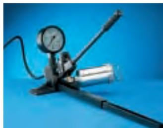
El bloque adaptador 226402 consiste en un bloque de fundición de acero en el cual puede ser conectado un manómetro, un tubo de alta presión y un inyector SKF 226400. Se entrega con una barra telescópica de apoyo y un racor a 90° para conexión del depósito de aceite.
